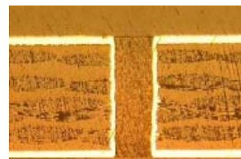
Hochplanare Oberfläche und blasenfreie Verfüllung nach dem Bürst/Schleifprozess (Foto: © Lackwerke Peters)
